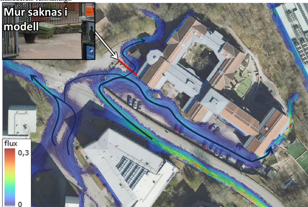
Figur 21. Maximal flödestäthet, flux ( m^3/s/m ), och inritade huvudsakliga rinnvägar vid skyfall, klimatkompenserat 100-årsregn.
