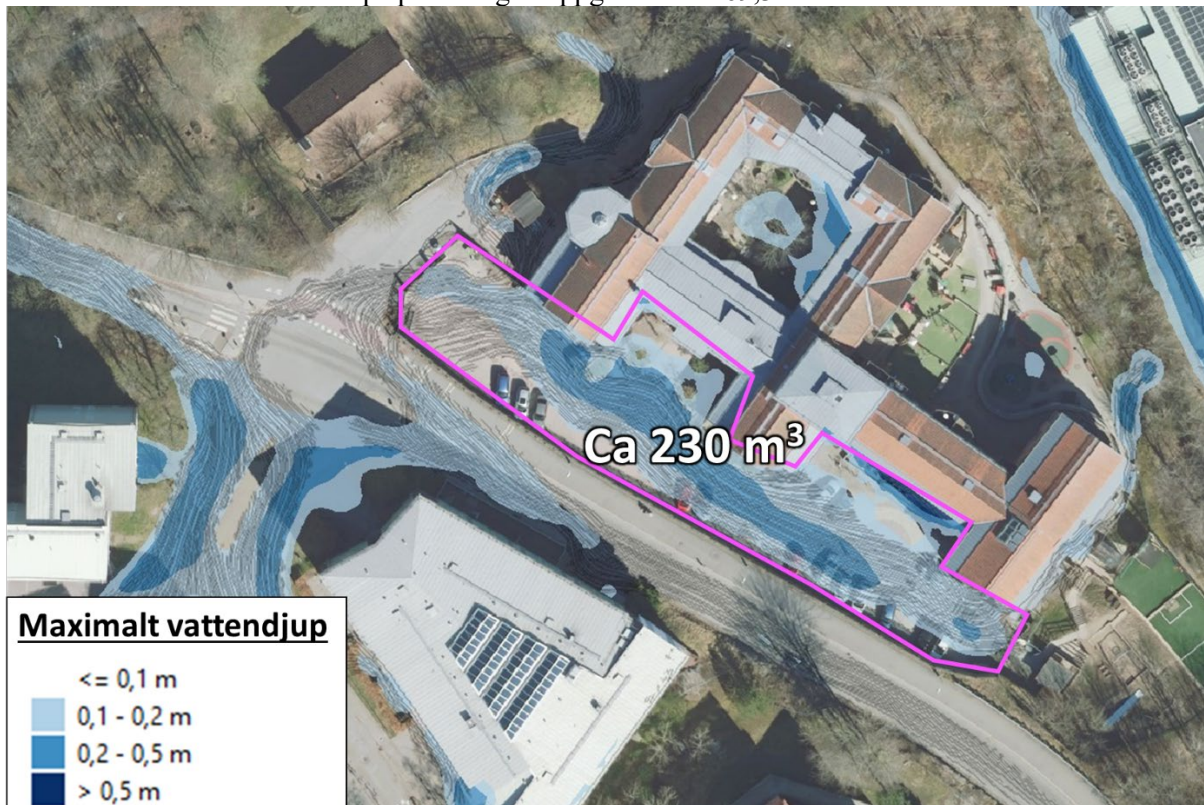
Figur 22. Maximalt vattendjup vid skyfall, klimatkompenserat 100-årsregn. Figuren visar även flödeslinjer och beräknad maximal förekommande vattenvolym på befintlig parkering inom planområdet.
